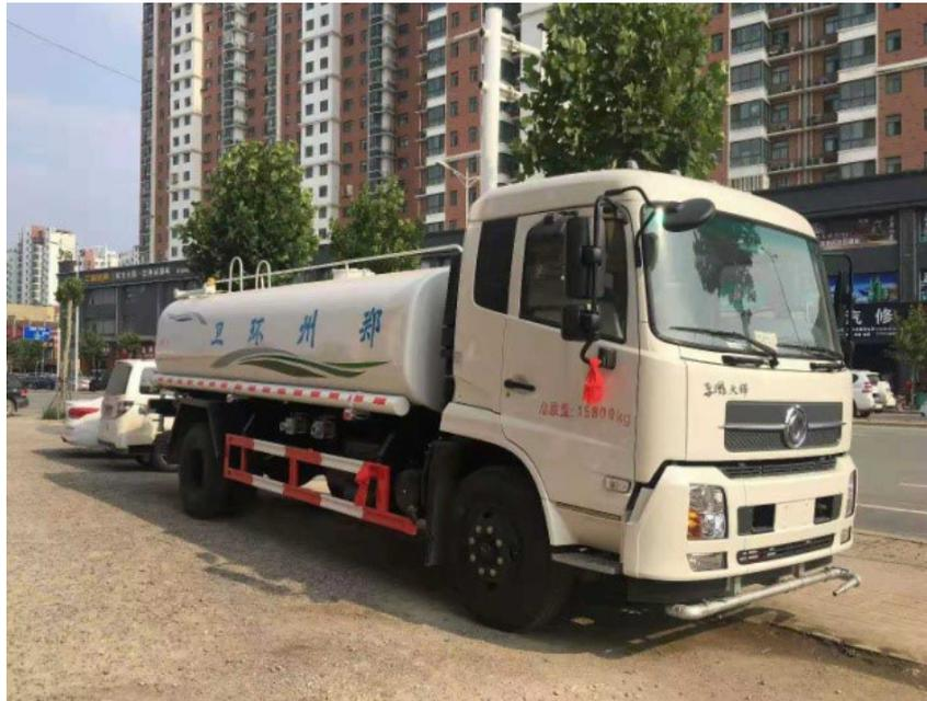
国六的多利卡D9洒水车和国五东风D9洒水车外形基本上一样，只不过是\*\*重要的心脏部位发动机升级换代成了更大马力输出的210马力康明斯\*\*\*技术。尾气排放上面也有很大的改变。这款车优势在哪呢？相比东风专底的底盘，这款车是东风总厂生产线出来的，做工方面和电路配件方面都是比\*\*底盘要扎实的，\*\*\*的小缺点就是变速箱是6档，这在路面非常差而且需要爬陡坡的情况下，这款车就没有专底的8档带副变速的好了。所以这款车大部分情况下是行驶在路面平整的路况。 中牟除尘洒水车出租粉尘的颗粒极大地影响了人们的健康。
